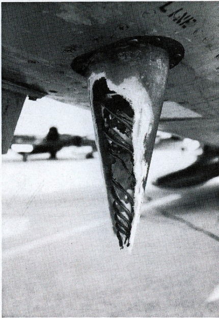
Ausgerissene Schraubverbindung durch Hagel Blitzeintritt und Hagelschlag a. e. Antenne
