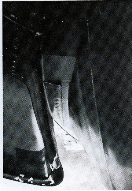
Ausgerissene Schraubverbindung durch Hagel Blitzeintritt und Hagelschlag a. e. Antenne
