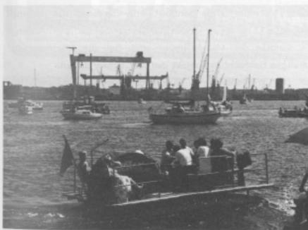
"Lila Lottchen" ist kein leichtes Mädchen, sondern ein schweres Tretboot: Länge 5 m, Breite 2,5 m, 2 Rümpfe, 1 Schaufelrad Durchmesser 1,60 m, Geschwindigkeit max. 3,5 Knoten, Baujahr 1981, 2 Mann in der Maschine, weitere 8-10 Mann passen auf, daß keiner das Bier klagt.
