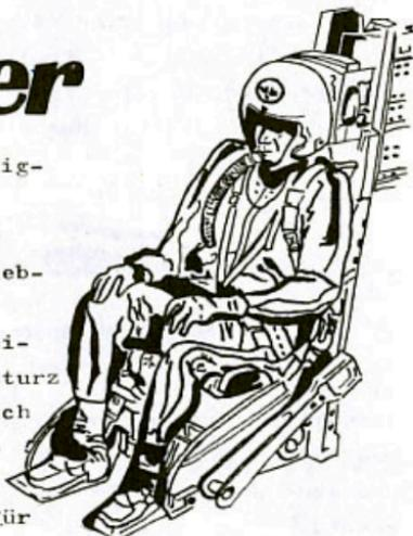
ist der Kabinendachabwurf. Eine teleskopartige Dreipatronenkanone, kombiniert mit einem Raketentreibsatz, schleudert selbst bei Geschwindigkeit "0" und Höhe "0", d. h. ohne Vorwärtsgeschwindigkeit und ohne in der Luft zu sein, den Sitz in rettungsfähige Höhe und bei Versagen des Dachabwurfes sogar durch das geschlossene Cockpit. Öffnung des Fallschirmes und das Herausheben des Piloten aus dem Sitz sind die Folgen einer automatisch ablaufenden Kettenreaktion.
